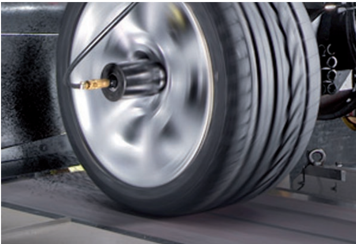
©IABG mbH - IABG Flachbahnreifenprüfstand Flat-Trac® III CT München /Ottobrunn
